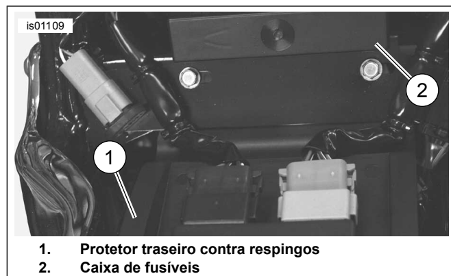
Figura 17. Proteção contra respingos, modelos Softail anos 2003 ou anteriores (modelo ano 2003 mostrado)
