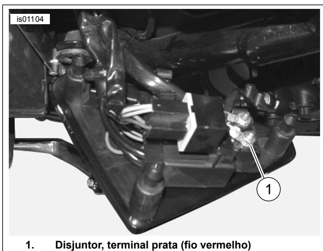
Figura 19. Disjuntor (Sportsters anos 2003 ou anteriores)
