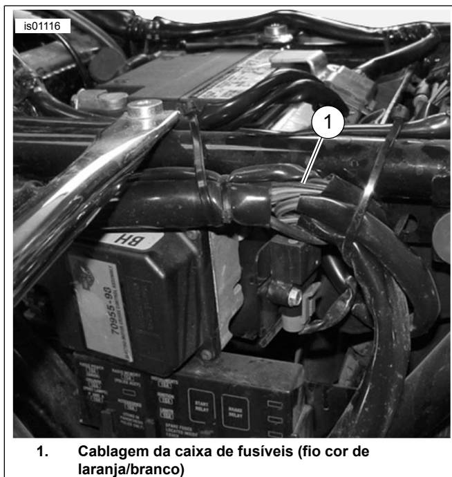
Figura 12. Cablagem da caixa de fusíveis atrás da tampa lateral esquerda, Modelos Touring ano 2003 ou anteriores (FLHTCUI apresentado)
