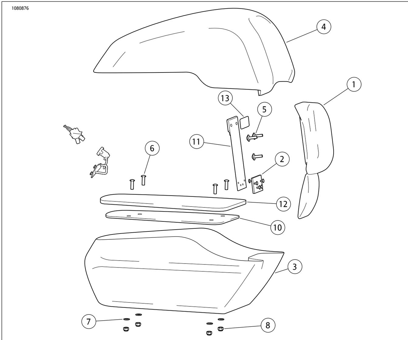
图1。维修零件：皮革Tour-Pak( 典型 )
