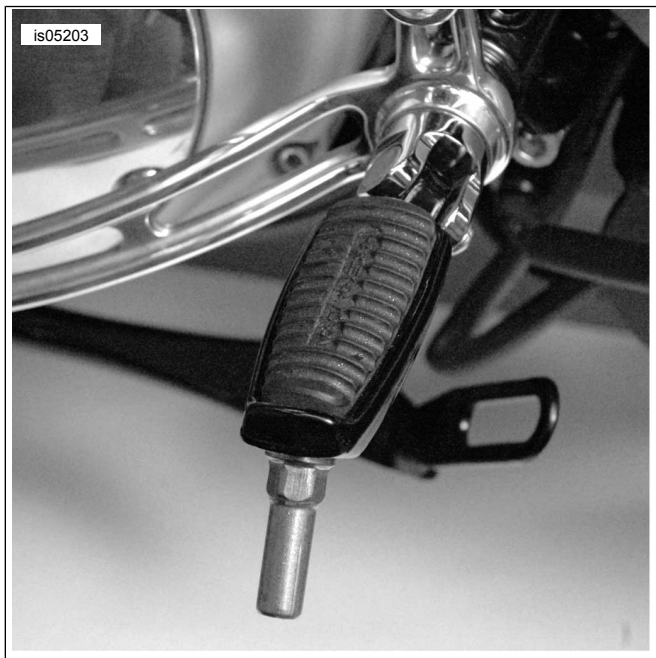
Afbeelding 2. Juiste installatie (algemene voetsteun en slijtagepen)
