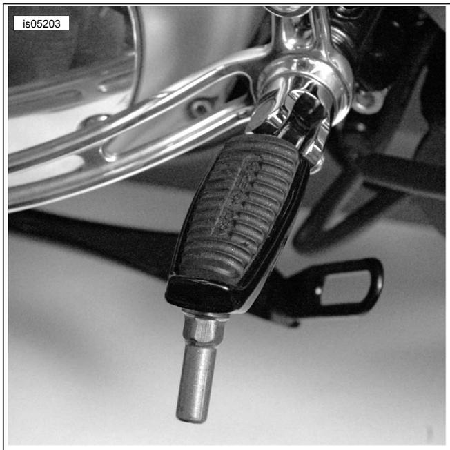
Figure 2. Installation correcte (appui-pied générique et pointe d'usure)
