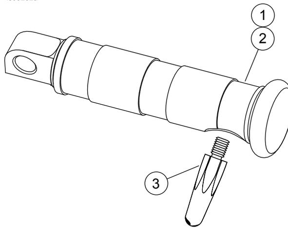
Figura 3. Parti di ricambio: Pedaline poggiapiedi e punta ad usura (kit 50695-08 illustrato)
