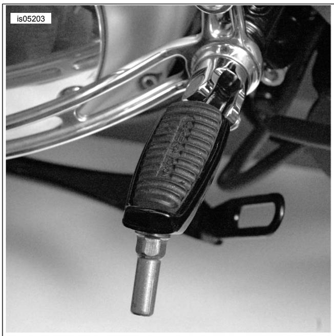
Figura 2. Installazione corretta (pedalina poggiapiedi e punta ad usura generiche)
