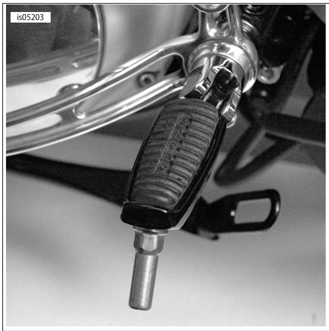
図2。正しい取り付け(一般的フットペグと摩耗チップ)
