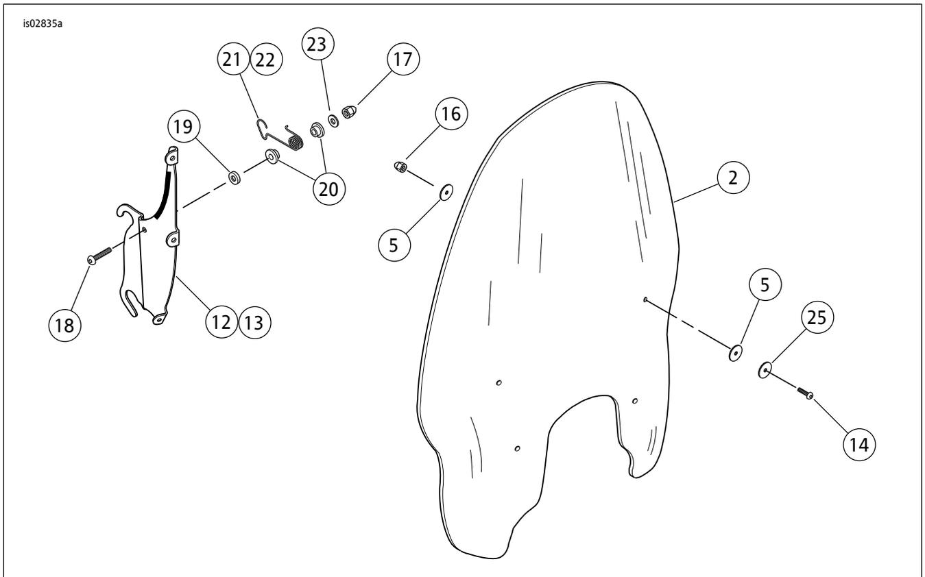
图4。维修零件：可拆卸式挡风玻璃套件57969-97A
