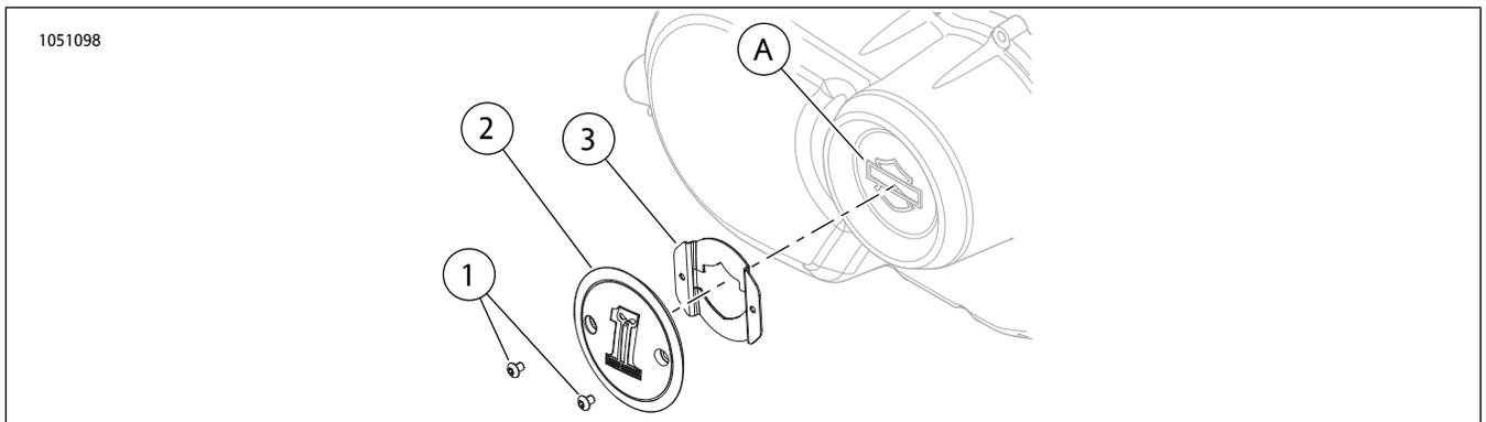
图1. 维修零件：主链箱盖装饰套件
