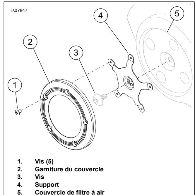
Figure 2. Installer le kit de couvercle
