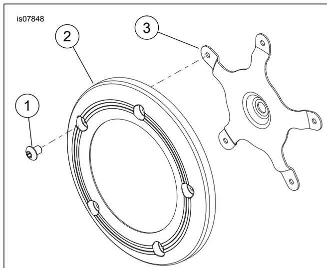
Figure 3. Pièces de rechange : kit de couvercle de boîte de filtre à air
