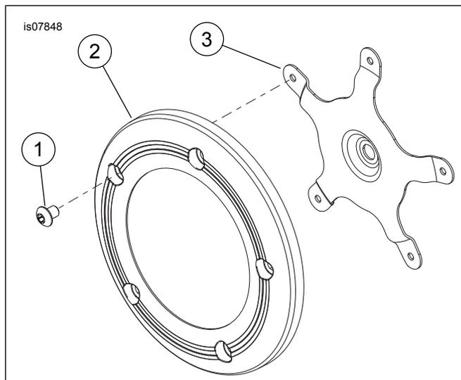
Figura 3. Parti di ricambio: Kit del coperchio del filtro dell'aria
