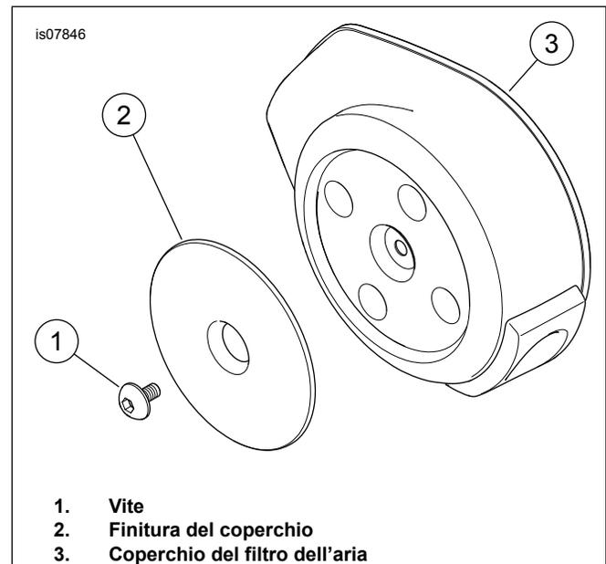
Figura 1. Rimozione della finitura originale
