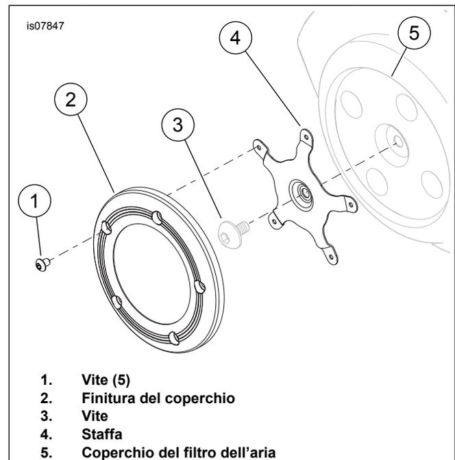
Figura 2. Installare il kit del coperchio
