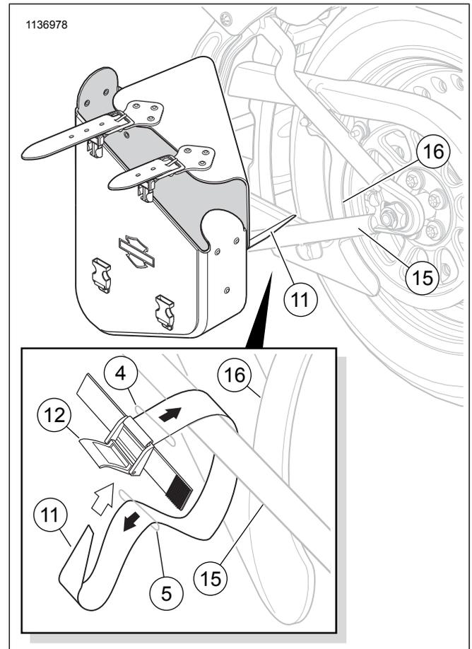
**Figure 7. Attachez la sangle inférieure - Softail 2018 et versions ultérieures**
