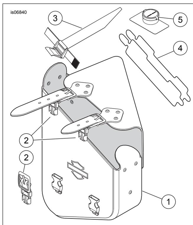
Figure 10. Pièces de rechange : Sac pour bras oscillant Softail
