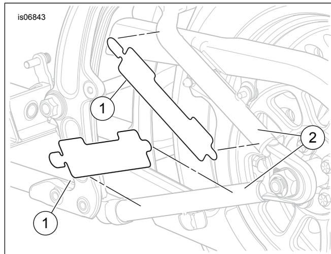
Figure 1. Installer le couvercle de protection (2)
