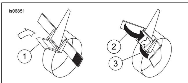
**Figure 6. Verrouiller et sécuriser la pince**
