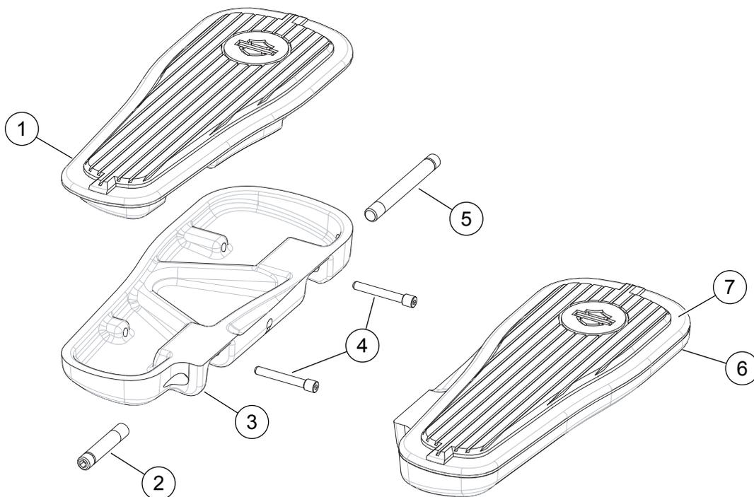
Рисунок 2. Запасные части: Комплект панели подножки пассажира
