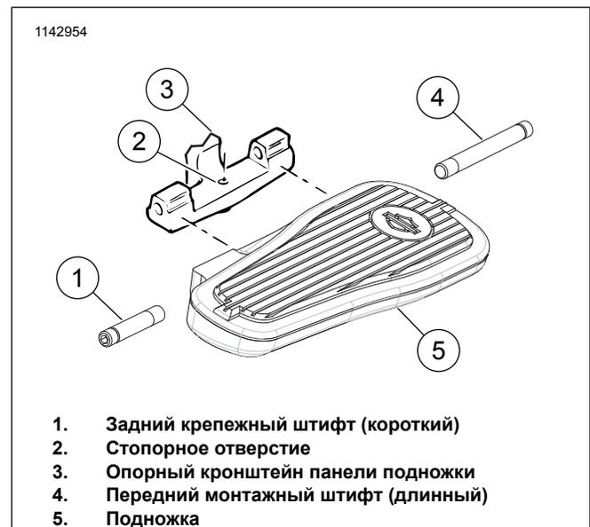
Рисунок 1. Панель подножки и опора
