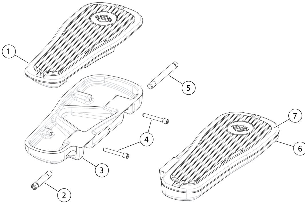
图2。维修零件：乘客脚踏板套件
