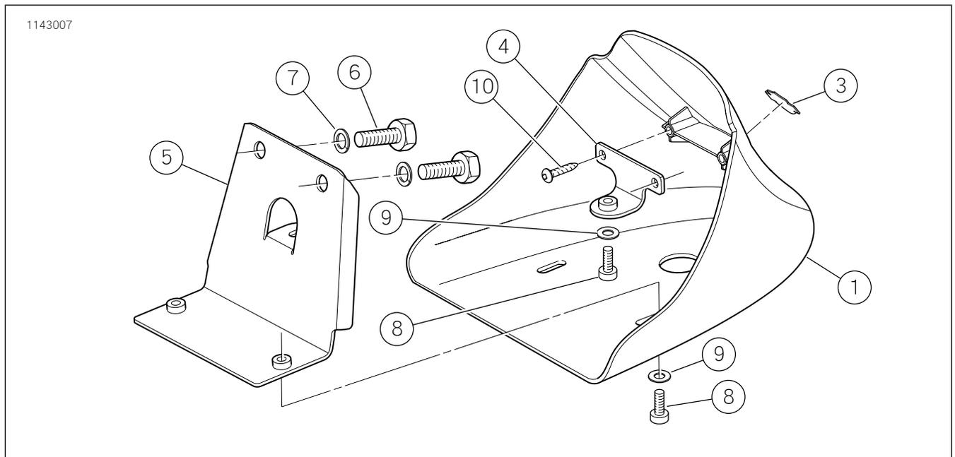
圖1. 維修零件前側擾流板工具包
