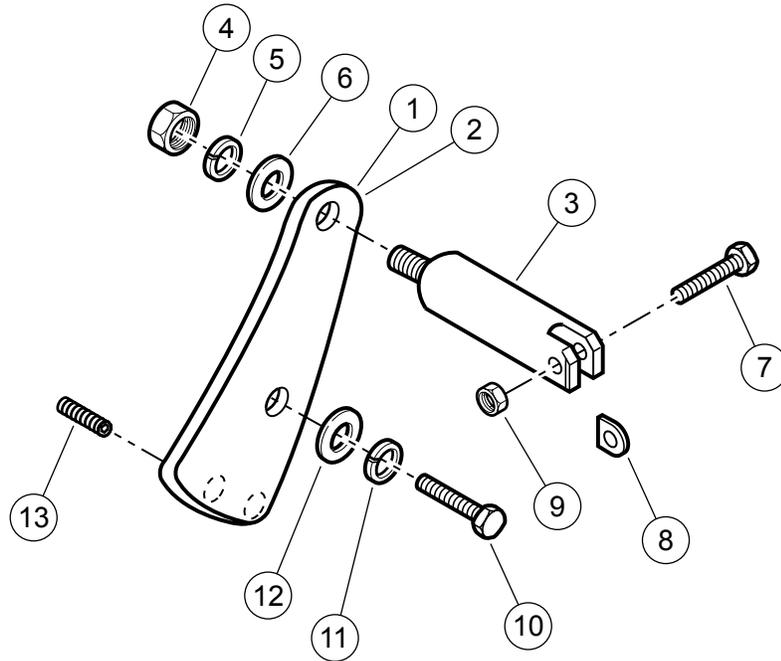
Figura 2. Piezas de servicio: Kit de montaje del taco apoyapiés para carretera ajustable de Dyna Glide
