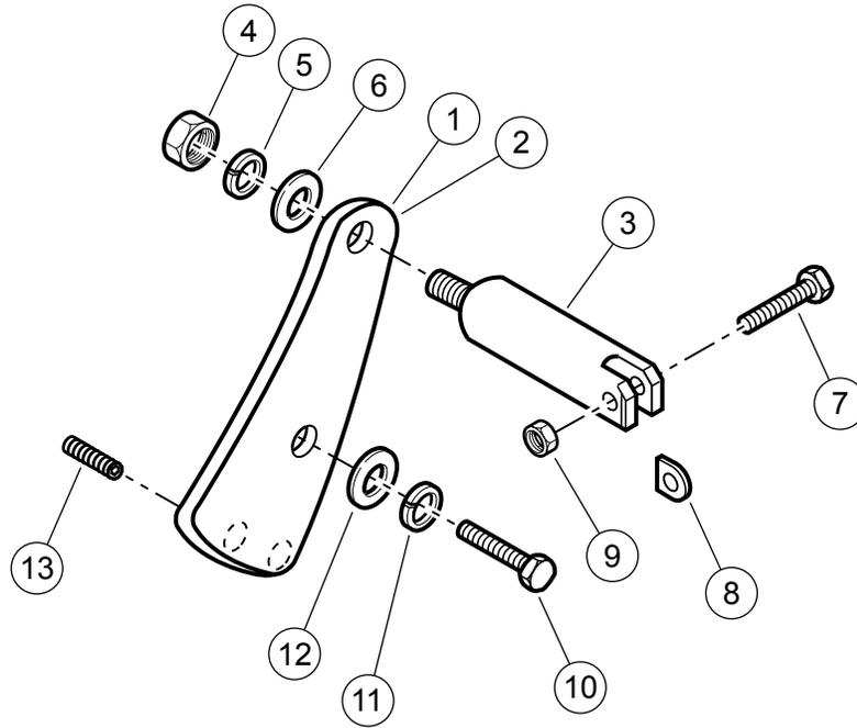
Figure 2. Pièces de rechange : Kit de montage repose-pied d'autoroute réglable Dyna Glide
