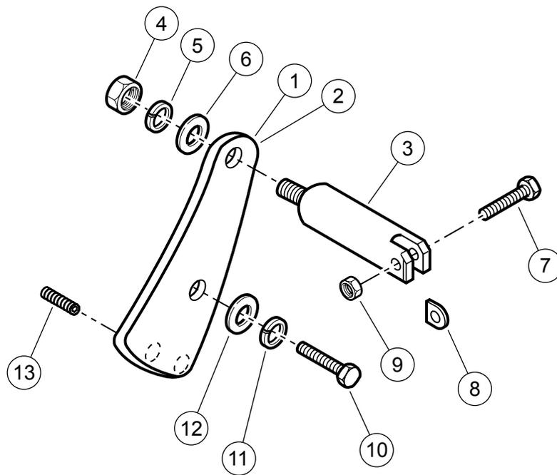
Figura 2. Parti di ricambio: Kit di montaggio pedalina regolabile highway per Dyna Glide
