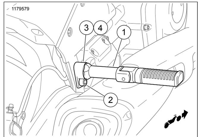
Abbildung 1. Ersatzteile: Soziusfußrasten-Adaptersatz
