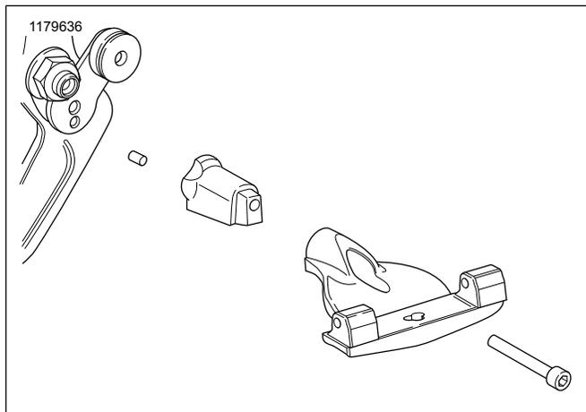
**Abbildung 6. Befestigung der abnehmbaren Satteltasche: Linke Seite**
