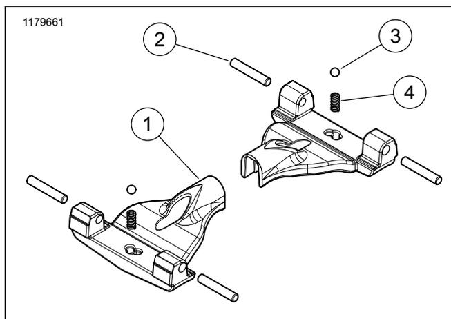
Abbildung 8. Ersatzteile: Sätze 50501113 und 50501114
