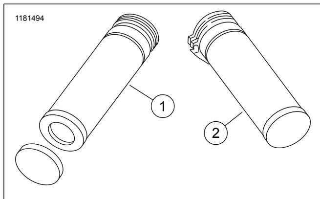
Figure 2. Pièces de rechange : Poignées de guidon
