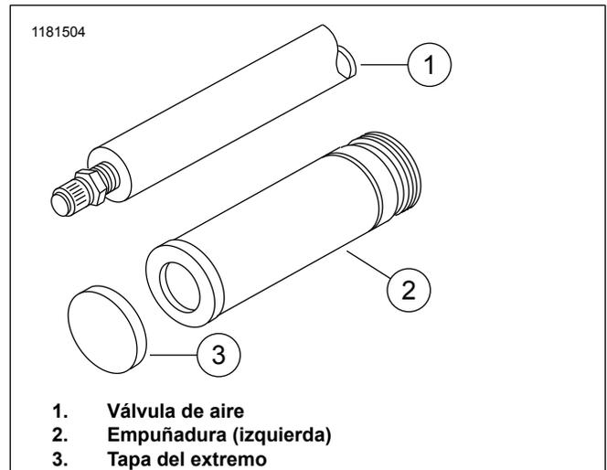
Figura 1. Alineación de la empuñadura del lado izquierdo con los extremos de la válvula de aire
