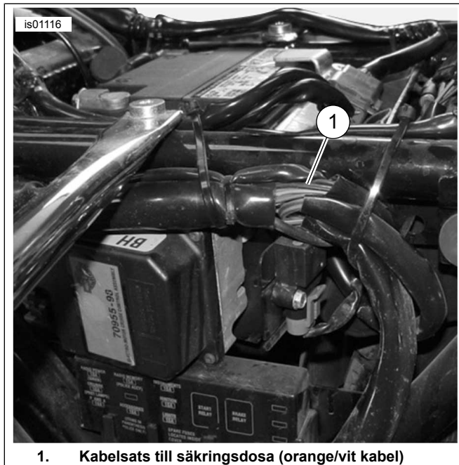
1. Kabelsats till säkringsdosa (orange/vit kabel) Figur 12. Kabelsats till säkringsdosa bakom den vänstra sidokåpan, Touring-modeller från 2003 eller tidigare (FLHTCUI visas)
