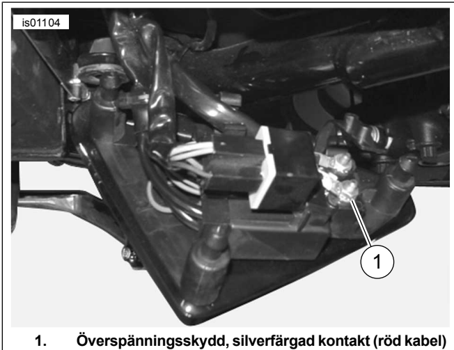
1. Överspänningsskydd, silverfärgad kontakt (röd kabel) Figur 19. Överspänningsskydd (Sportster-modeller från 2003 eller tidigare)
