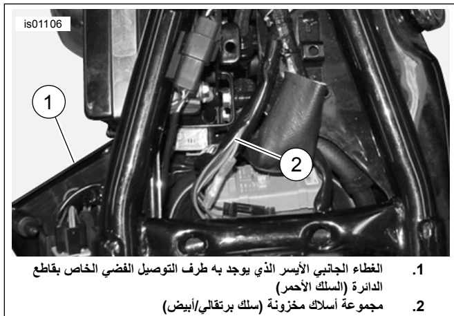
الشكل 11. توصيلات الطاقة (موديلات XL)
