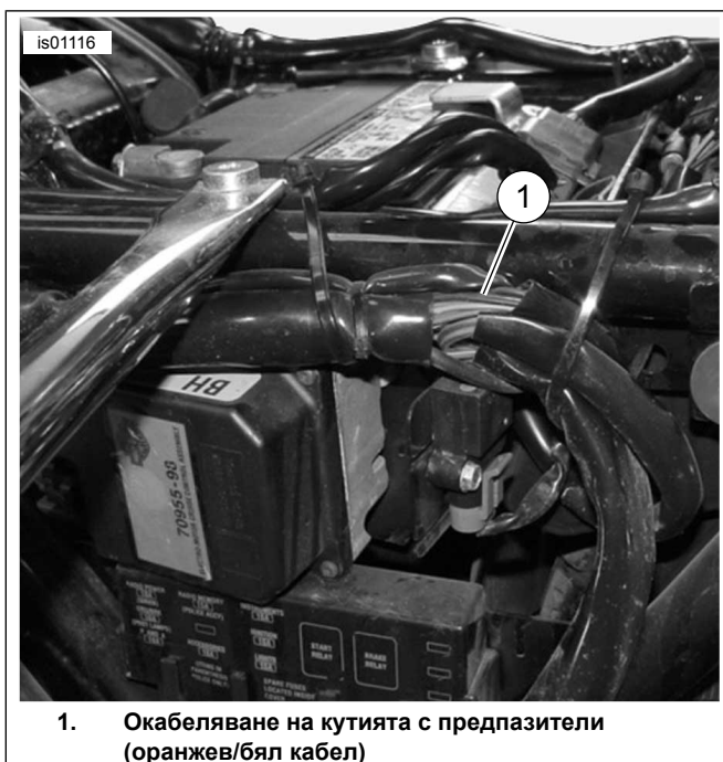
Фигура 12. Окабеляване на кутията с предпазители зад левия страничен капак, модели Touring 2003 г. или по-ранни (показан е FLHTCUI)
