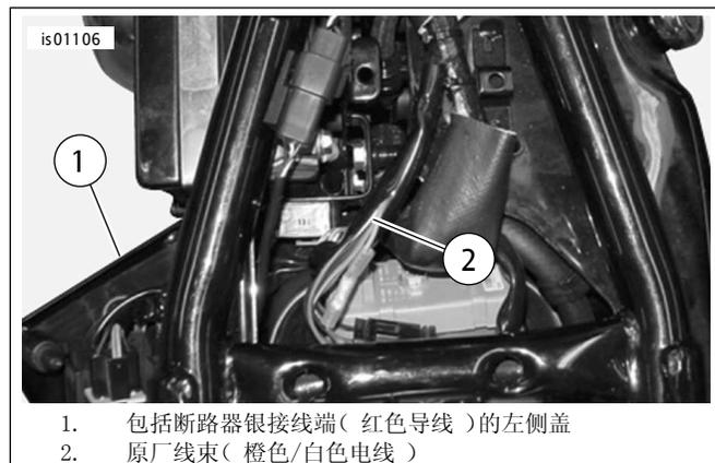
1. 包括断路器银接线端(红色导线)的左侧盖
