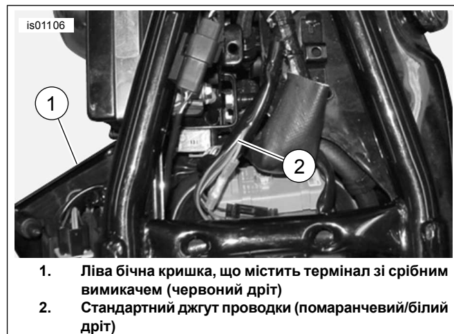
Малюнок 11. Електричні підключення (Моделі XL)
