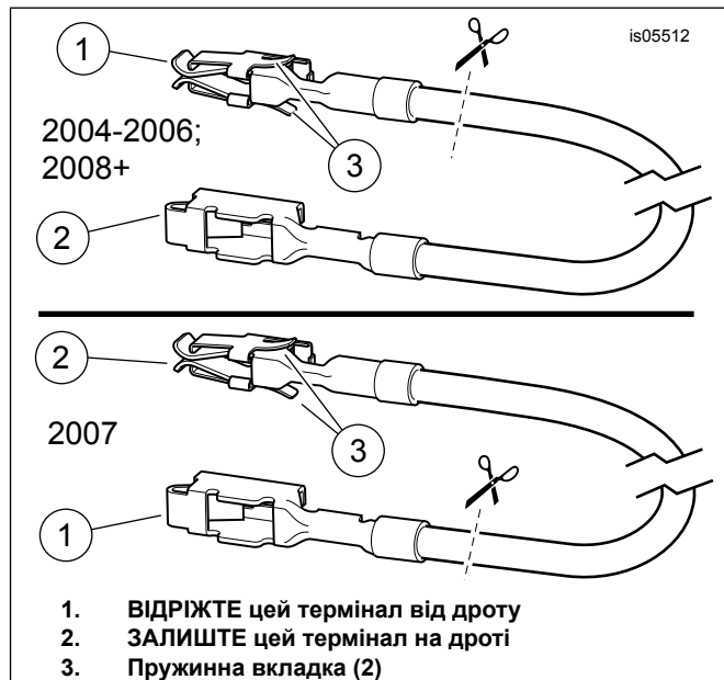
Малюнок 13. Дріт адаптера з блоку запобіжника (FL Touring)
