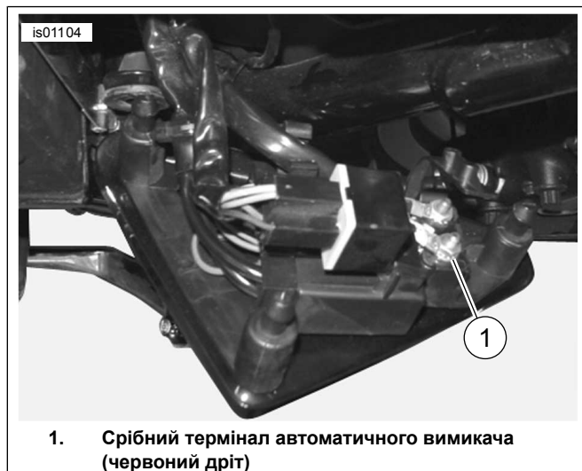
Малюнок 19. Автоматичний вимикач (Моделі Sportsters 2003 року або раніше)
