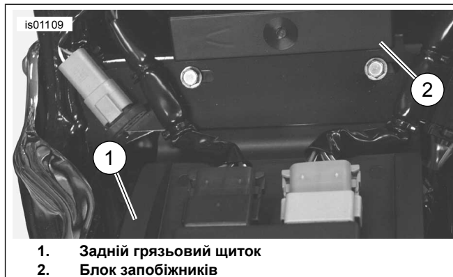
Малюнок 17. Splash Guard 2003 р. або раніші моделі Softail (показано модель 2003 р.)
