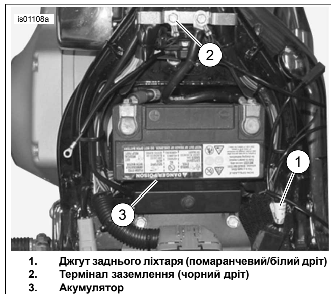
Малюнок 3. Силлові підключення та підключення заземлення (для моделей Softail)
