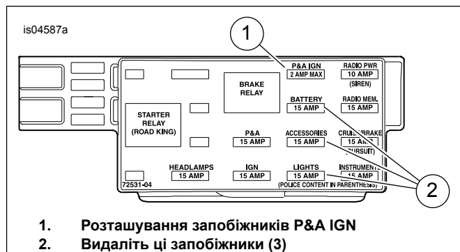
Малюнок 14. Порожнина для запобіжників P&A IGN (Моделі Touring 2004-2007 рр.)
