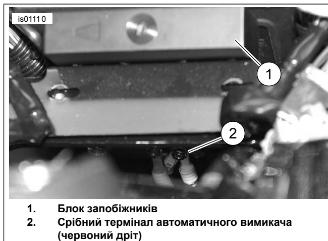
Малюнок 18. Автоматичний вимикач (Моделі Softails 2003 року або раніше)
