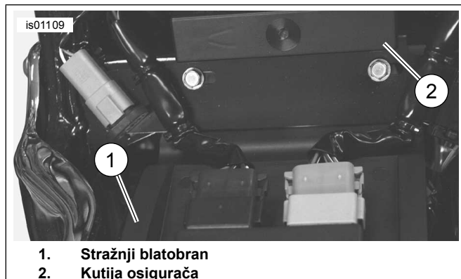
Slika 17. Blatobran, 2003. i stariji Softail modeli (prikazuje se model iz 2003.)
