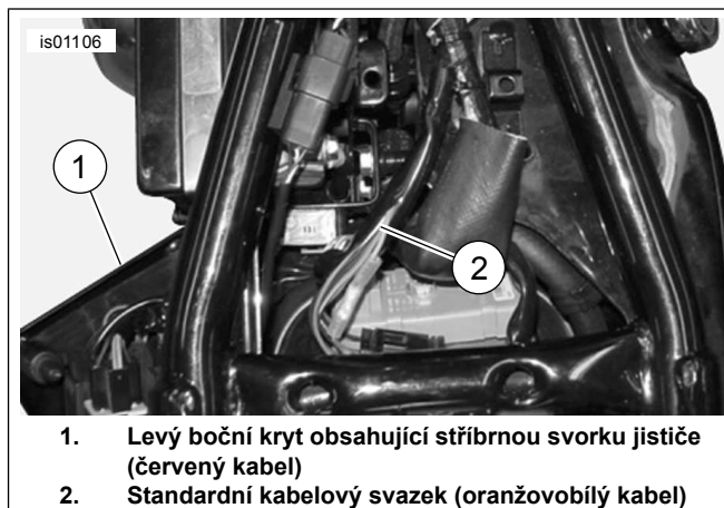
Ilustrace 11. Připojení napájení (modely XL)
