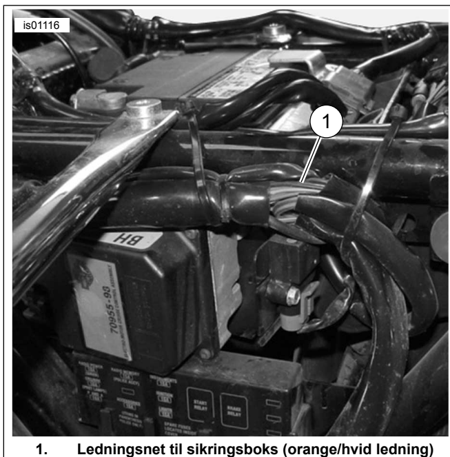
Figur 12. Sikringsboksens ledningsnet bag venstre sideskærm, Touring-modeller fra 2003 eller tidligere (FLHTCU vist)
