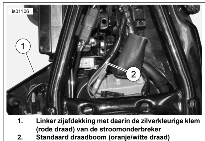
Afbeelding 11. Stroomaansluitingen (XL-modellen)
