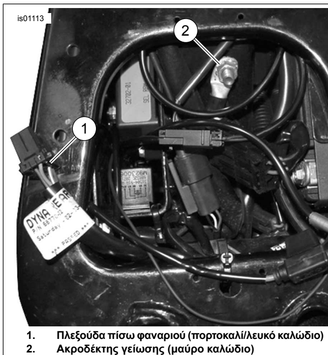
Εικόνα 2. Συνδέσεις ισχύος και γείωσης (μοντέλα Dyna)
