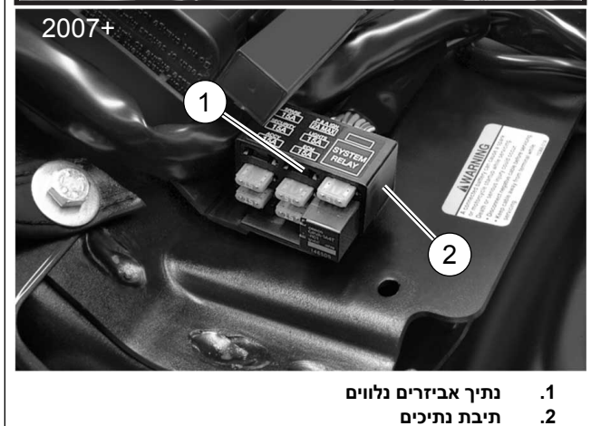
תרשים 15. המיקומים של נתיכים נלווים (דגמי V-Rod)
