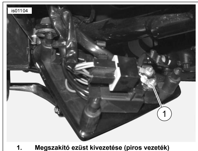
Ábra 19. Megszakító (2003-as vagy régebbi Sportster modellek)
