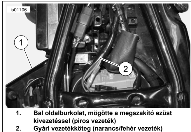
Ábra 11. Tápcsatlakozások (XL modellek)
