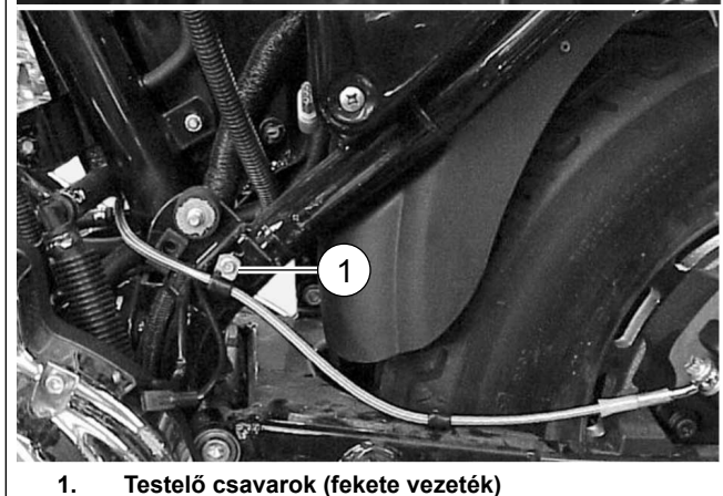
1. Testelő csavarok (fekete vezeték) Ábra 4. Testcsatlakozók (Sportster modellek)
