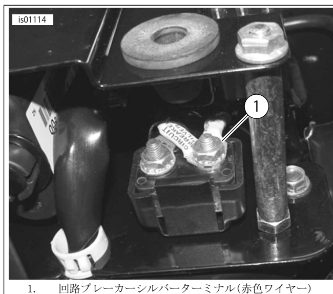
図16. ダイナモデルの接続(2003年以前のモデル)、左サイドカバーを外した状態を下から見た図
