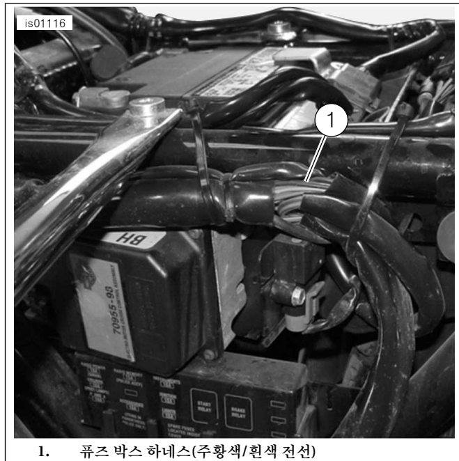
그림 12. 2003 이전 Touring 모델 왼쪽 측면 덮개 뒤 퓨즈 박스 하네스(FLHTCUI 표시됨)
