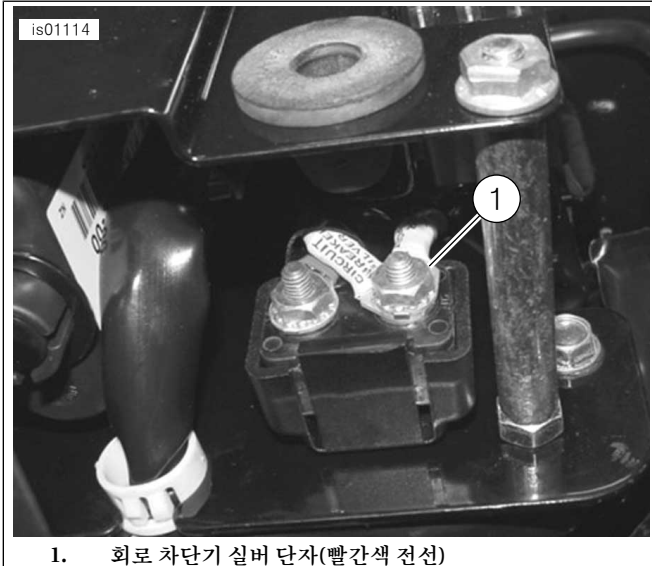
그림 16. 제거된 왼쪽 측면 덮개의 바닥에서 본 Dyna 연결부(2003 이전 모델)
