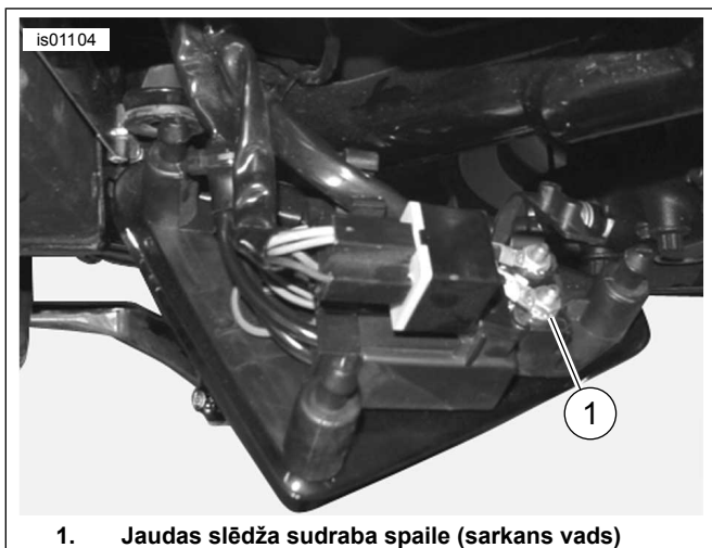
Attēls 19 Jaudas slēdzis (2003. gada vai vecākiem Sportster modeļiem)
