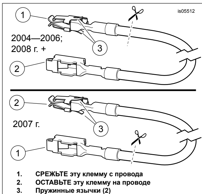
Рисунок 13. Провод адаптера блока предохранителей (FL Touring)
