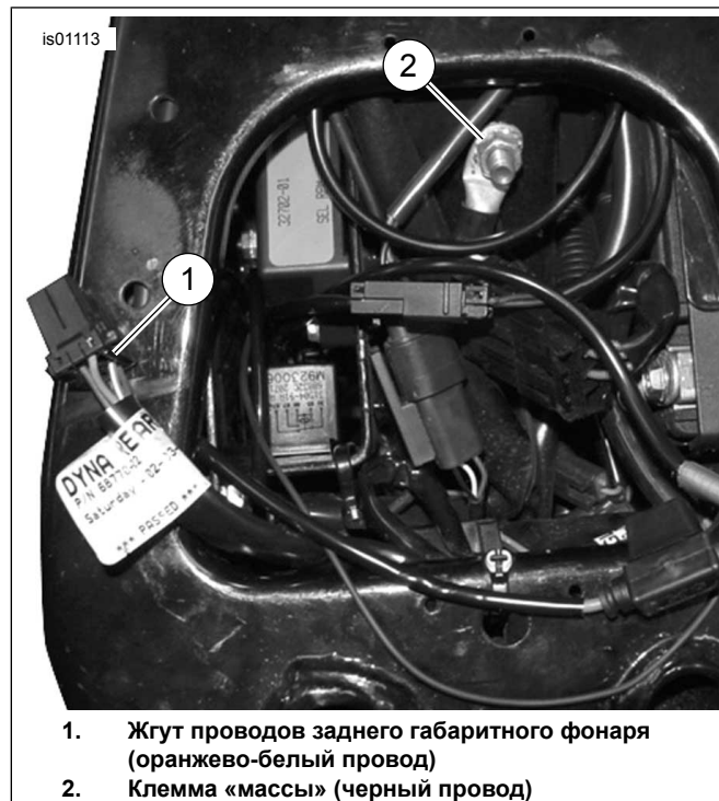
Рисунок 2. Провода питания и «массы» (модели Dyna)
