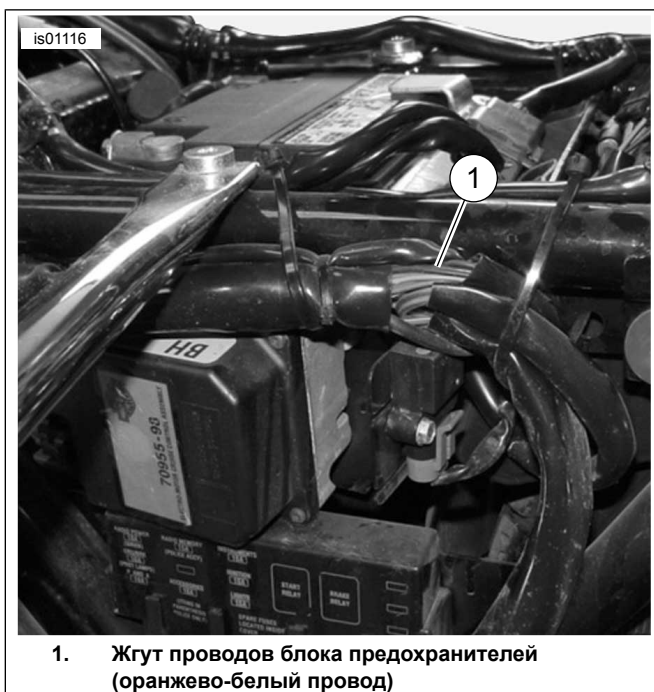
Рисунок 12. Жгут проводов блока предохранителей за крышкой с левой стороны, модели Touring 2003 или более ранних годов (на рисунке показана модель FLHTCUI)
