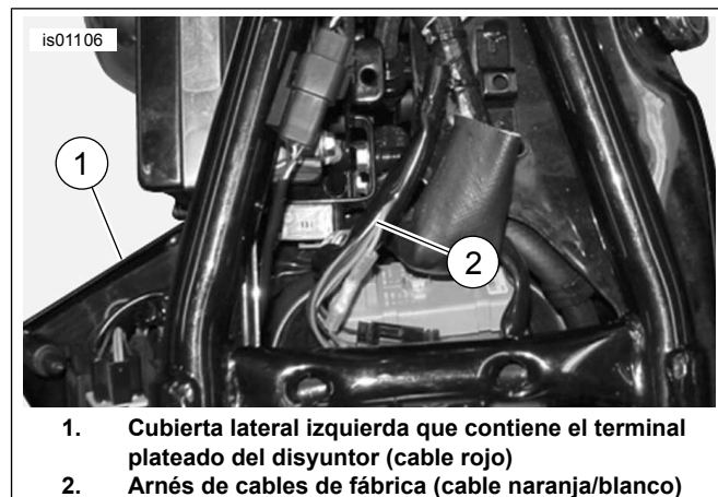
Figura 11. Conexiones de alimentación (modelos XL)
