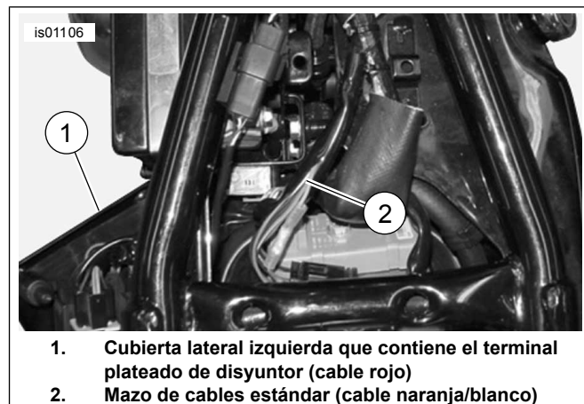
Figura 11. Conexiones de alimentación (modelos XL)
