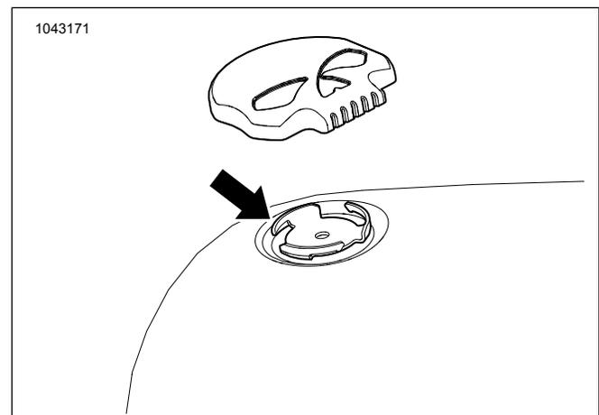
Figura 1. Patilhas de alinhamento do tampão do depósito do lado esquerdo
