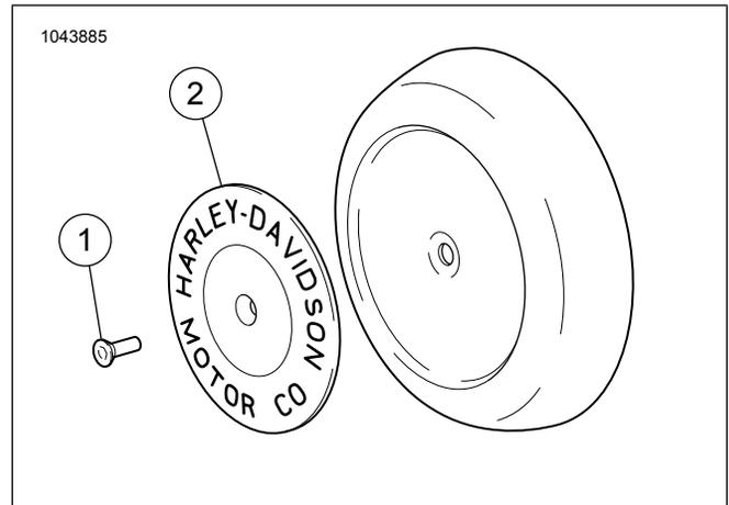
Figure 1. Couvercle du boulon central
