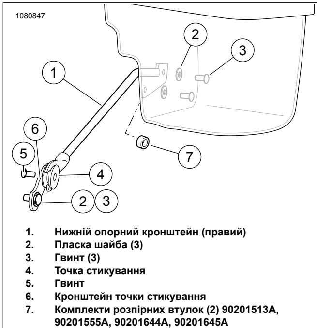
Малюнок 4. Нижній опорний кронштейн
