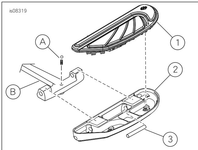
圖2。維修零件氣流乘客腳踏板
