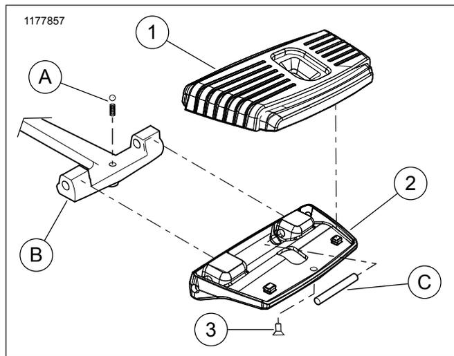
圖3。維修零件氣流乘客腳踏板（套件50501151，50501228）
