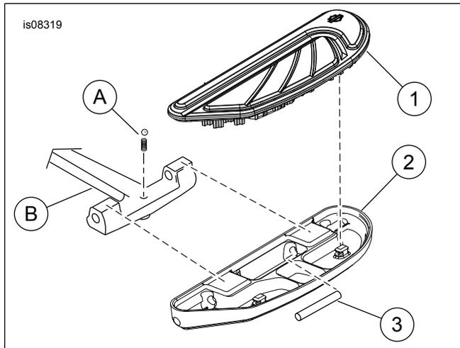
Figure 2. Pièces de rechange : Marchepied passager Airflow
