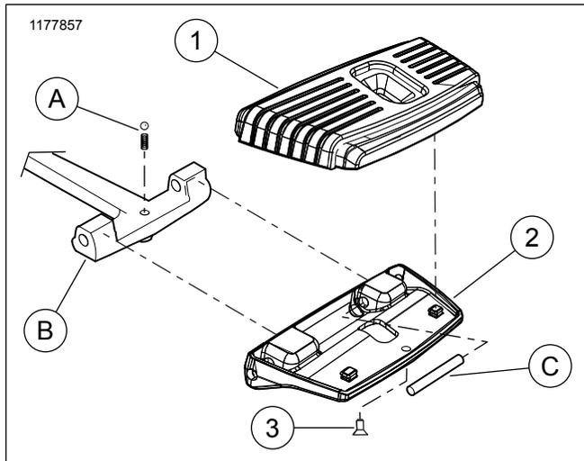
Figure 3. Pièces de rechange : Marchepied passager Airflow (kits 50501151, 50501228)
