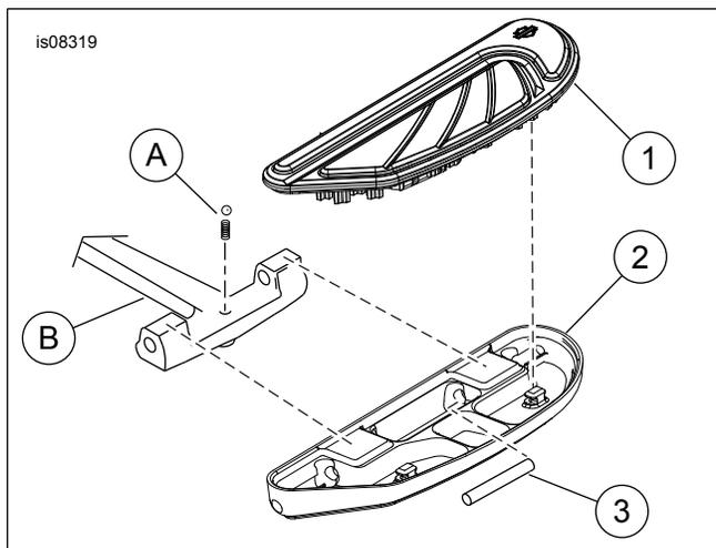
Figura 2. Peças de reposição: Estribo do passageiro Airflow
