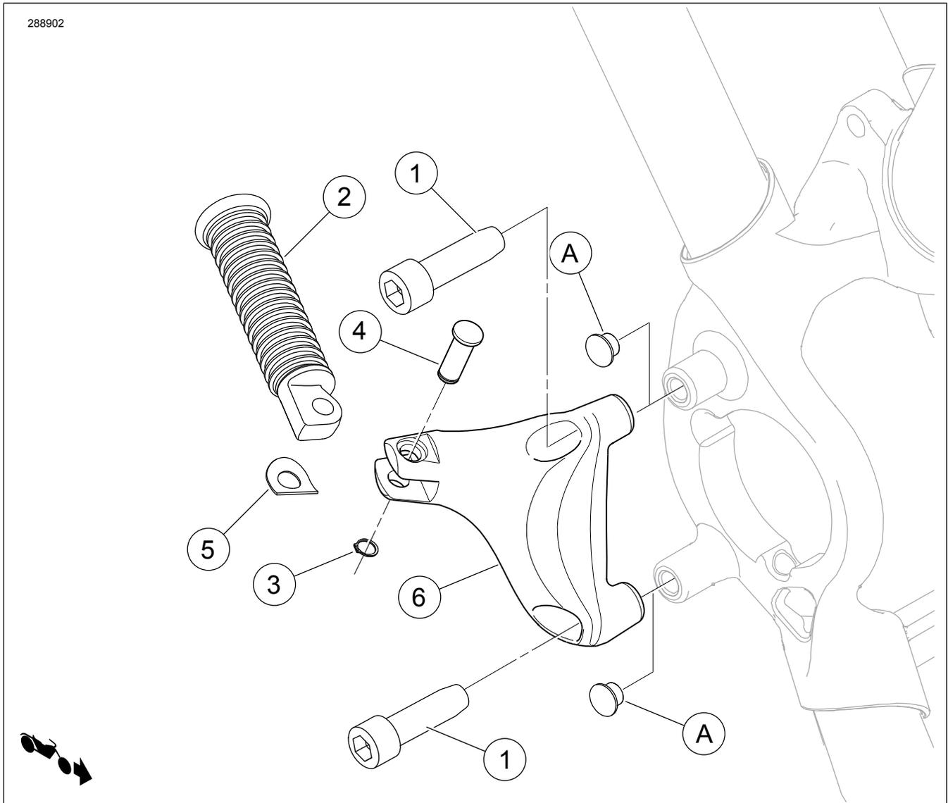
Figure 1. Contenu du kit : kit de montage pour repose-pied passager
