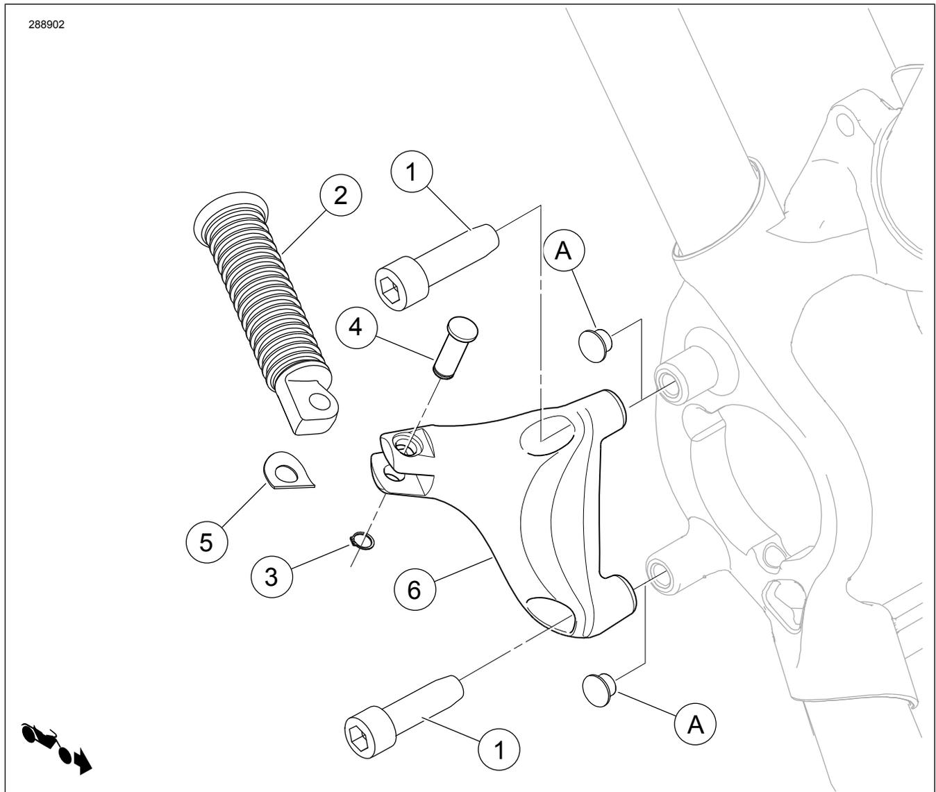
Abbildung 1. Inhalt des Satzes: Soziusfußrasten-Befestigungssatz
