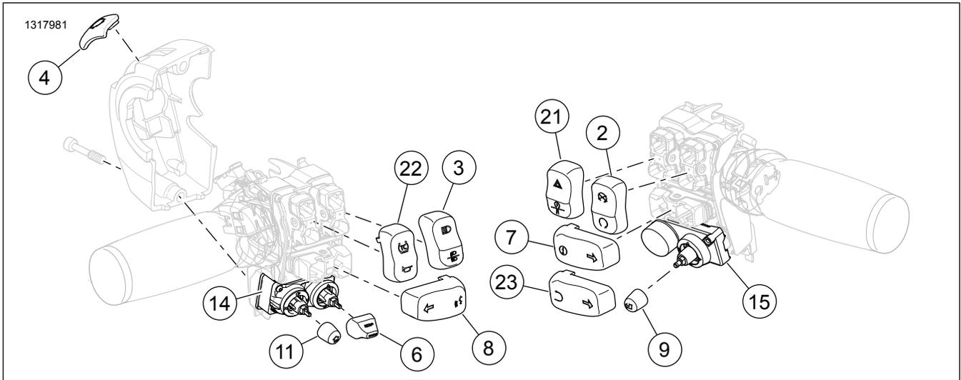
Abbildung 4. Ersatzteile für 71500515: Lenkerschalterkappen, verchromt
