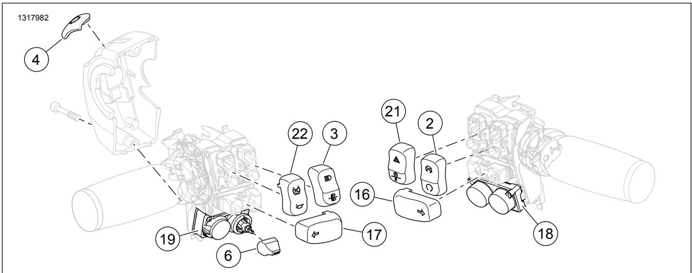
Abbildung 5. Ersatzteile für 71500517: Lenkerschalterkappen, verchromt
