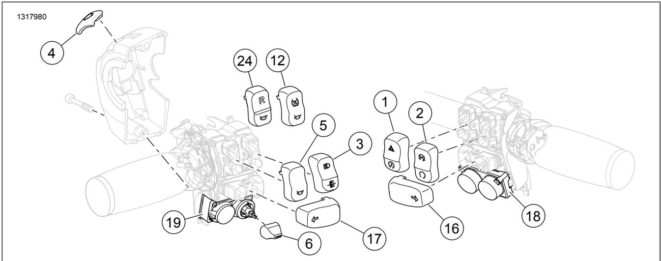
Abbildung 3. Ersatzteile für 71500186A: Lenkerschalterkappen, verchromt
