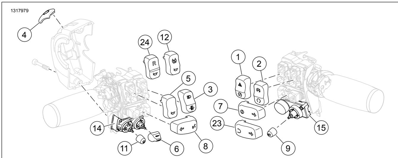
Abbildung 2. Ersatzteile für 71500187C: Lenkerschalterkappen, verchromt
