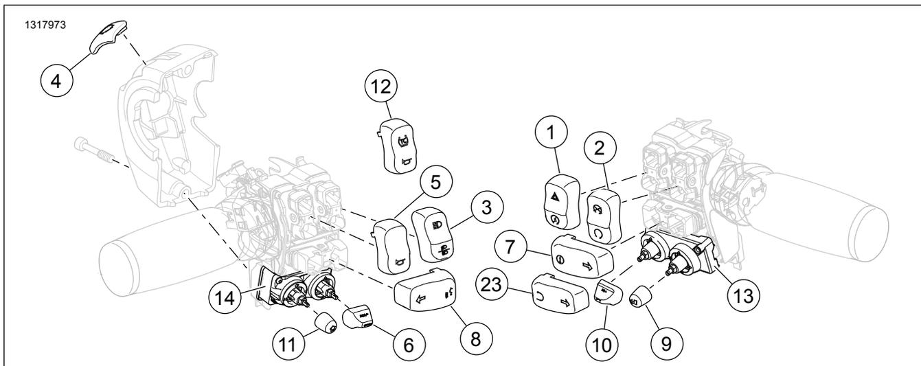
Abbildung 1. Ersatzteile für 71500228C: Lenkerschalterkappen, verchromt
