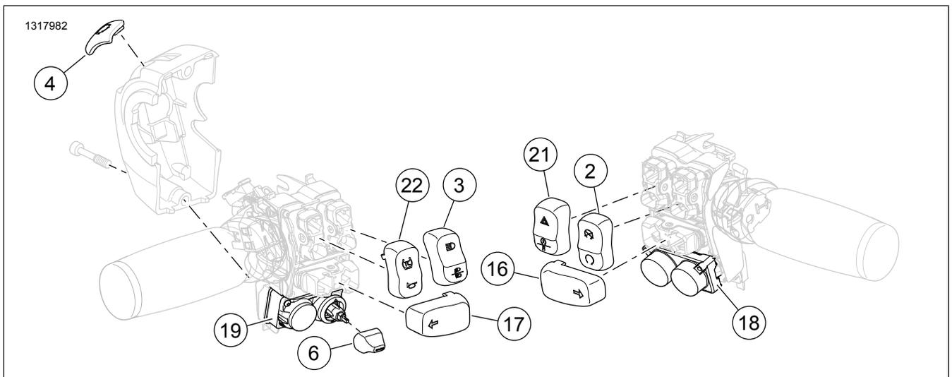
**Figura 5. Peças de reposição para 71500517: Tampas dos interruptores do guidador cromadas**
