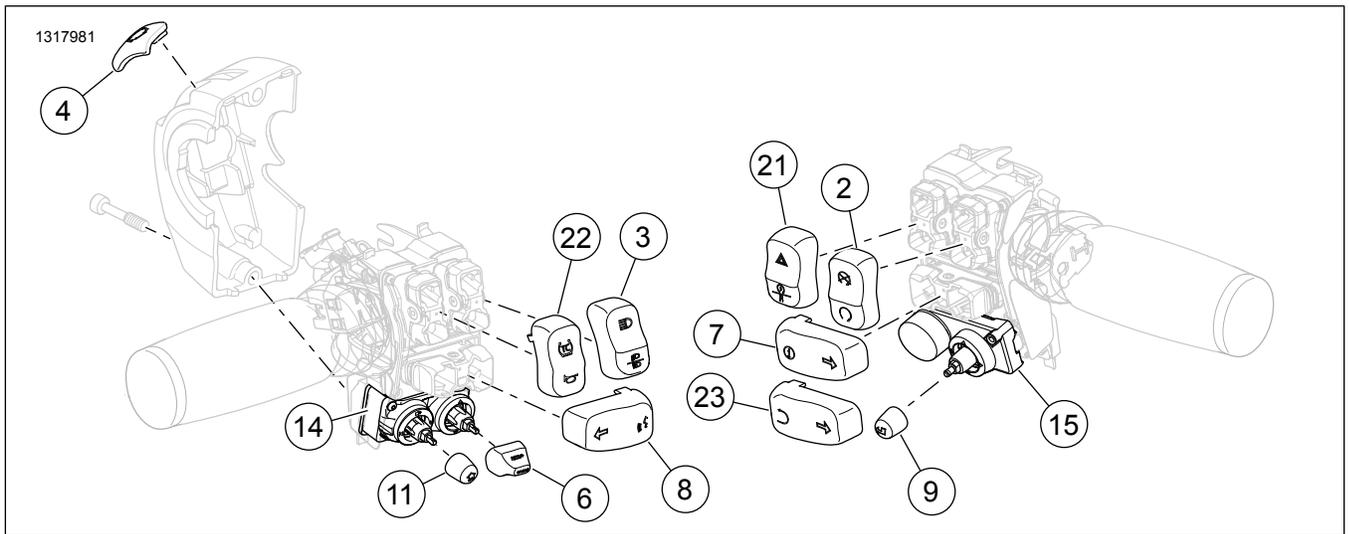
**Figura 4. Peças de reposição para 71500515: Tampas dos interruptores do guidador cromadas**
