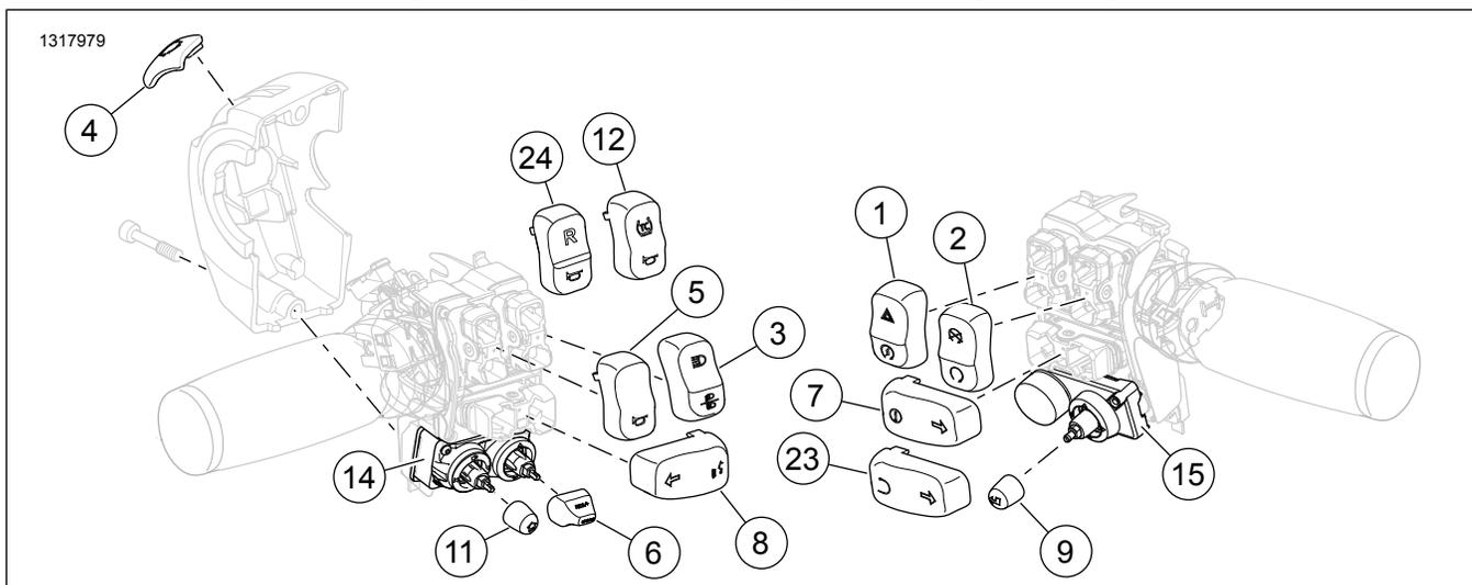
Figura 2. Peças de reposição para 71500187C: Tampas dos interruptores do guidão cromadas
