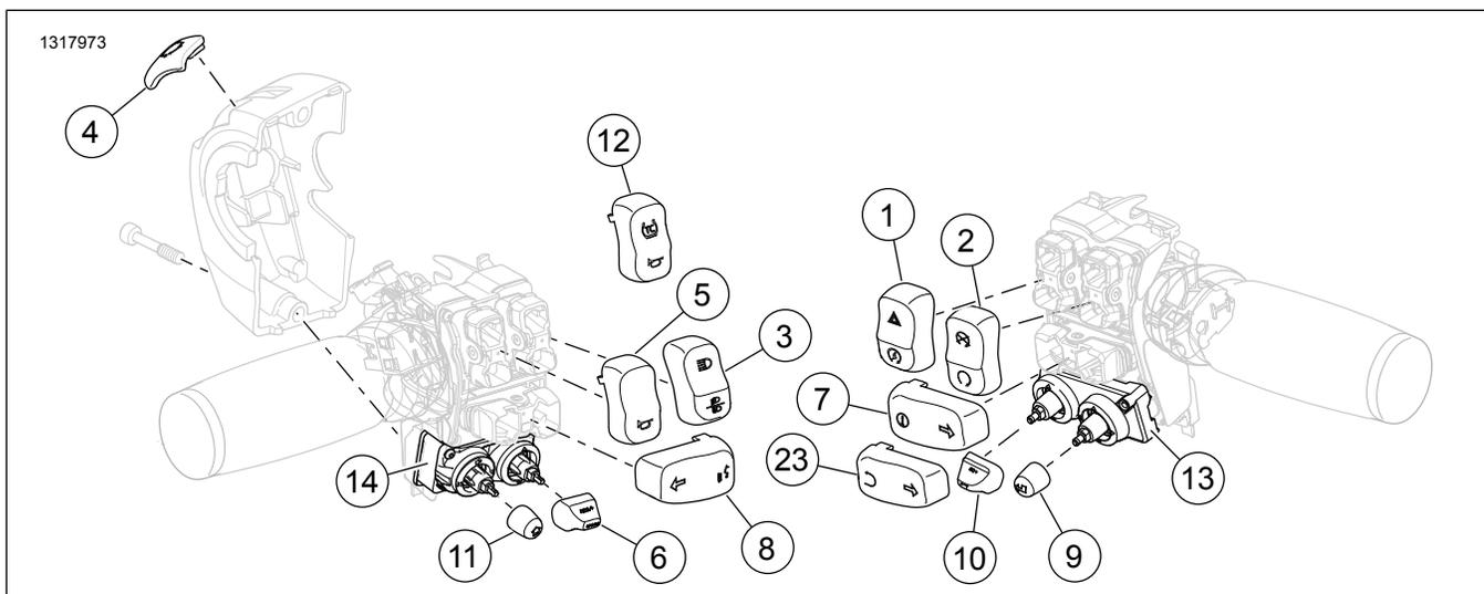
Figura 1. Peças de reposição para 71500228C: Tampas dos interruptores do guidão cromadas
