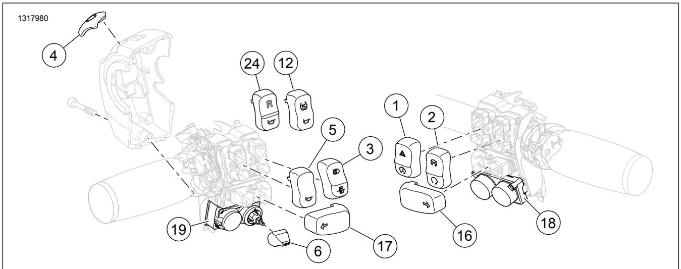
**Figura 3. Peças de reposição para 71500186A: Tampas dos interruptores do guidador cromadas**
